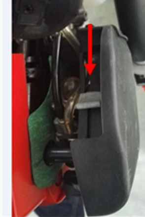
Klapa startowa zamknięta (dźwignia klapy startowej z dala od zbiornika paliwa)
