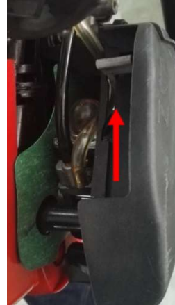
Klapa startowa otwarta (dźwignia klapy rozruchowej do zbiornika paliwa)
