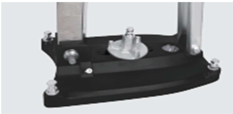
Grondplaat van de Kernboorinstallatie bevestigd met draadstang en schijfveugelmoer
