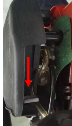
Clapet de démarrage ouverte
