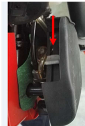
Tapa de arranque cerrada (palanca de la trampilla de arranque lejos del depósito de combustible)
