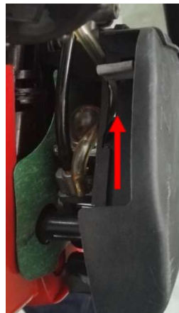
Tapa de arranque abierta (palanca de la aleta de arranque al depósito de combustible)
