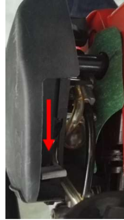
Startklep open (Startklephendel omlaag)
