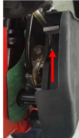
Startklep open (startklephendel naar de brandstoftank)
