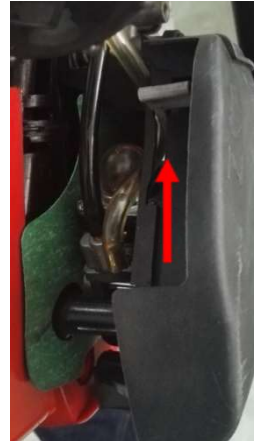
Porte de départ ouverte (levier du volet de démarrage vers le réservoir de carburant)
