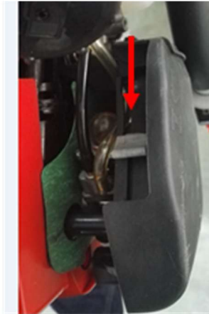
Clapet de démarrage fermé (levier du volet de démarrage loin du réservoir de carburant)
